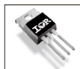
3.4 pav. IRFZ44N tranzistoriaus standartinė schema [19]
