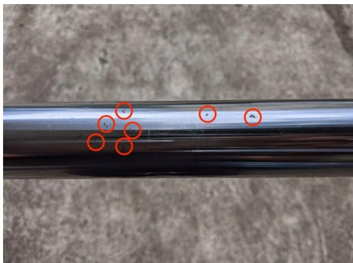
5 pav. Pažeistas korozijos priekinių amortizatorių vamzdis. Šaltinis: https://motofomo.com/motorcycle-forks-faq/
