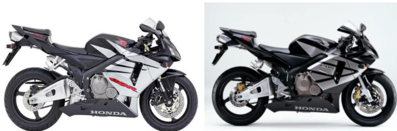
1 pav. Dviejų modifikacijų motociklas Honda Cbr600rr. Kairėje su verstomis priekinėmis šakėmis, dešinėje su įprastomis hidraulinėmis. Šaltinis: https://motofomo.com/motorcycle-forks-faq/
