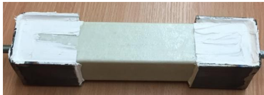
B3 pav. Klijuotinės jungties bandinys (aliuminis + stiklo pluoštas)
