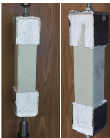
B5 pav. Klijuotinių jungčių tempimo bandymai
