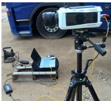
4.5 pav. Sparčiojo filmavimo sistemos „Phantom v711“ bendras vaizdas
