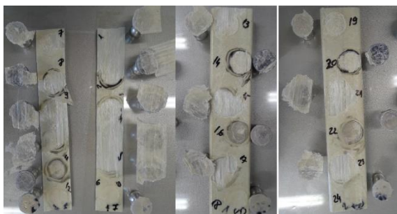
3.2 pav. Tinkamiausių klijų parinkimo bandymai
