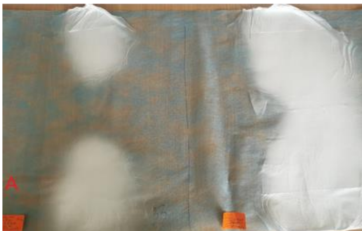
13 pav. Elektriniu verpimu suformuotos PVB dangos ant PP pagrindo
