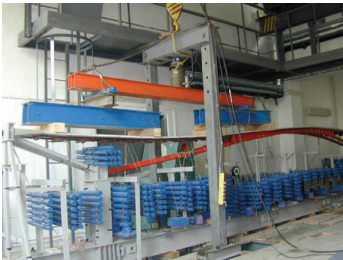
1.8 pav. Statinis modelis, ribinė apkrova (Strasky J. 2008)
