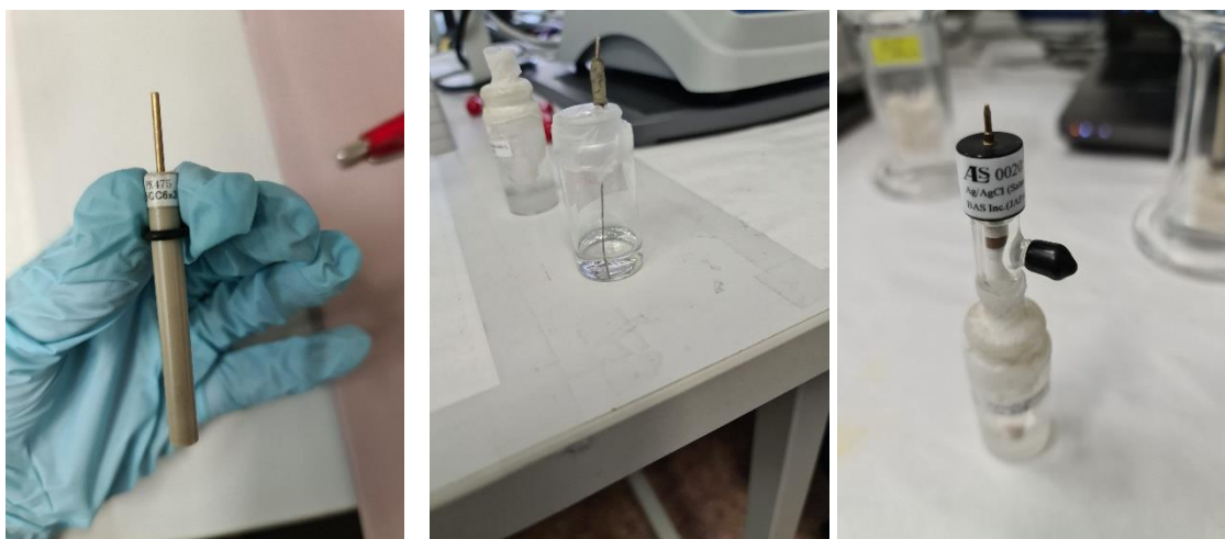
2.5 pav. Kairėje – PGE elektrodo nuotrauka, per vidurį – pagalbinio Pt elektrodo nuotrauka, o dešinėje – palyginamojo Ag/AgCl elektrodo nuotrauka.
