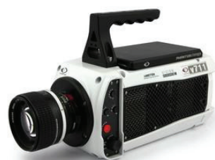
2.3 pav. Matavimo įranga: a) Aplinkos oro parametrų matuoklis Testo 445; b) temperatūros duomenų kaupiklis PicoLogger TC-08; c) greitaigė vaizdo kamera Phantom v711
