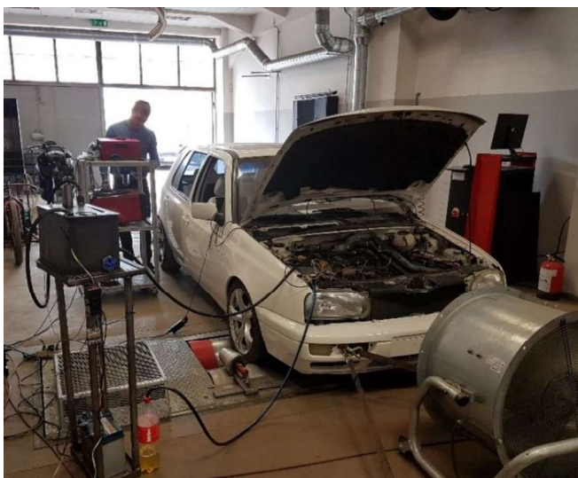
1 pav. Variklio rodiklių matavimas naudojant lengvųjų automobilių apkrovos stendą „CARTEC LPS 2510“
