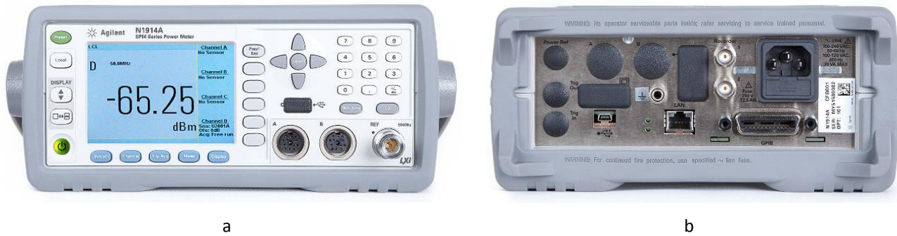
3.1 pav. Agilent N1914A dviejų kanalų galios matuoklis, vaizdas iš priekio (a) ir galo (b)
