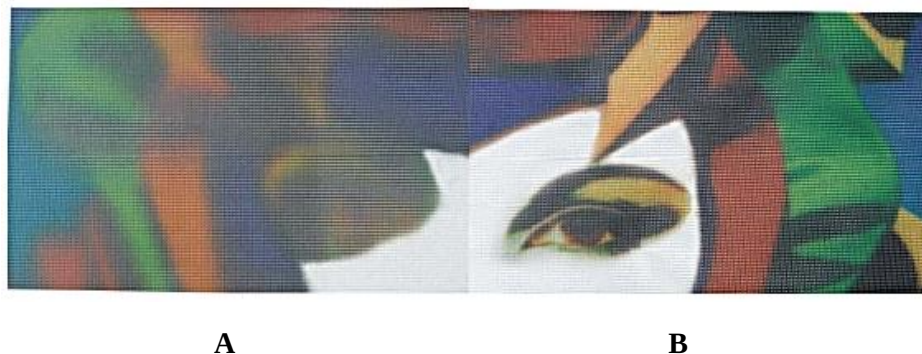
32 pav. Dažų įsiskverbimas į ne apdorotą (A) ir apdorotą (B) specialiu junginiu audinį. [41]
