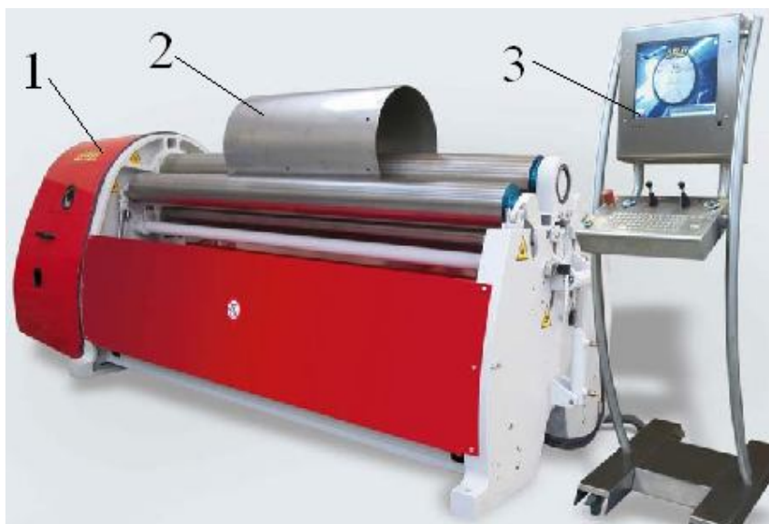
2.1 pav. Valcavimo staklės „DAVI MCA-2020“: 1 – staklės; 2 – ruošinys; 3 – valdymo pultas
