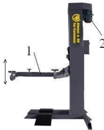
2.2 pav. Keltuvas „AA4C- AA-SPGJ2.5“: 1- slankiojanti gembė; 2- elektros variklis
