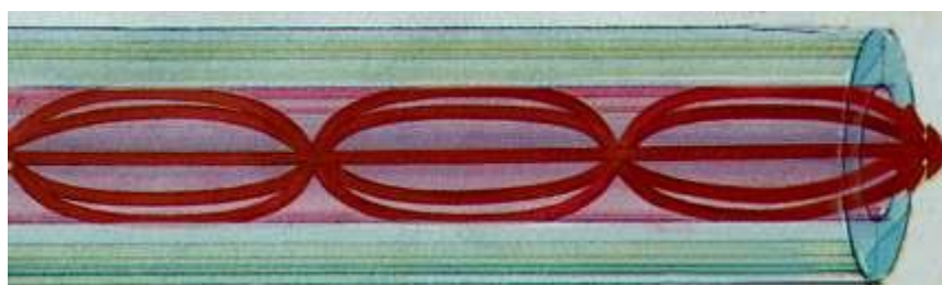
5 pav. Gradientinio lūžio rodiklio šviesolaidis.
