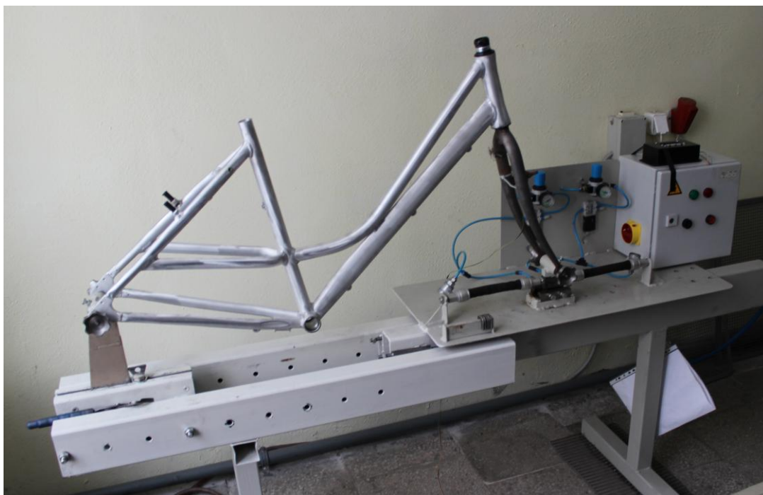
2.1.7 pav. Dviračių rėmų bandymo stendas
