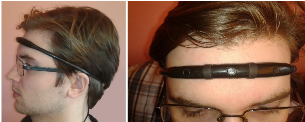
27 pav. „OCZ NIA“ įrenginio montavimo pavyzdys.
