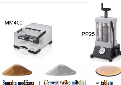
Sumalta medžiaga + Licowax vaško milteliai = tabletė
