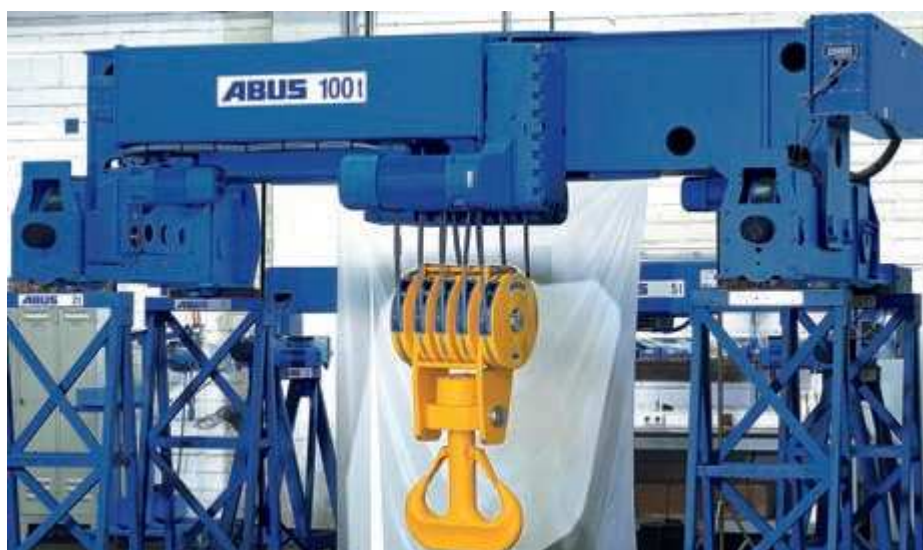
2.3.2.3 pav. Dviejų bėgių elektrinė talė
