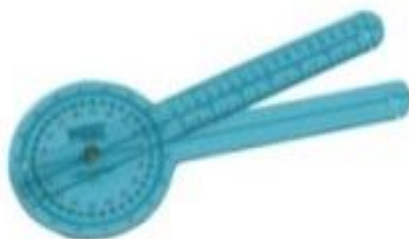
5pav. Goniometras, judesių amplitudėms išmatuoti
