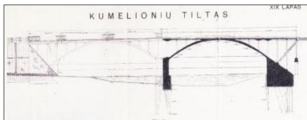
133 pav. Kumelionių arkinio tilto fasadas ir išilginis pjūvis.
