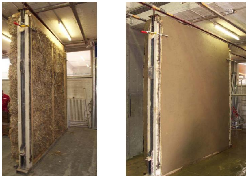
22 pav. Tinkuotos šiaudinės sienos degumo bandymas
