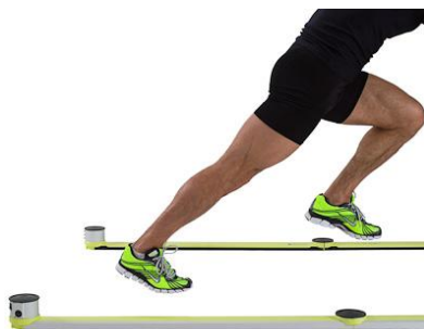
6 pav. Atsispyrimo trukmės matavimo prietaisas „OptoJump“ ( http://www.optojump.com )
