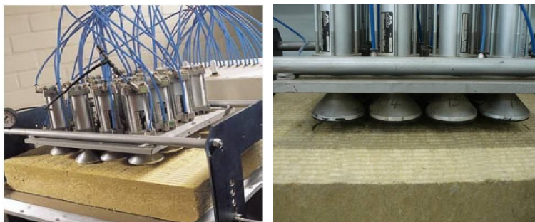
2.6 pav. Dinaminės apkrovos bandymo mašina ir pats bandymas
