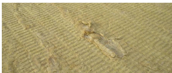
4.17 pav. Struktūros defektas gaminio paviršiuje
