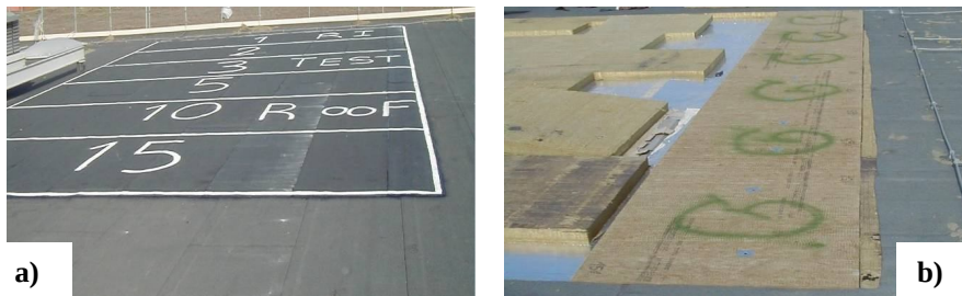
5.7 pav. Akmens vatos plokštės eksploatuojamo plokščiojo stogo konstrukcijoje: a – plokštės bandinių išėmimo metu; b – bandymo poligonas
