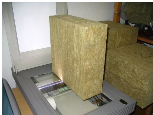
2.12 pav. Bandinio paviršiaus nuskaitymas skaitytuvu Fig. 2.12. Scanning of surface of test specimen by scanner
