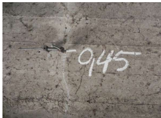
5.9 pav. Įstrižojo plyšio pločio pokyčio matavimas pirmojo tarpatramio perdangos ketvirtos pagrindinės sijos viduryje
