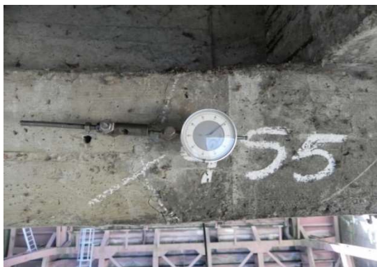
5.8 pav. Normalinio plyšio pločio pokyčio matavimas pirmojo tarpatramio perdangos penktos pagrindinės sijos viduryje, apatinėje lentynoje
