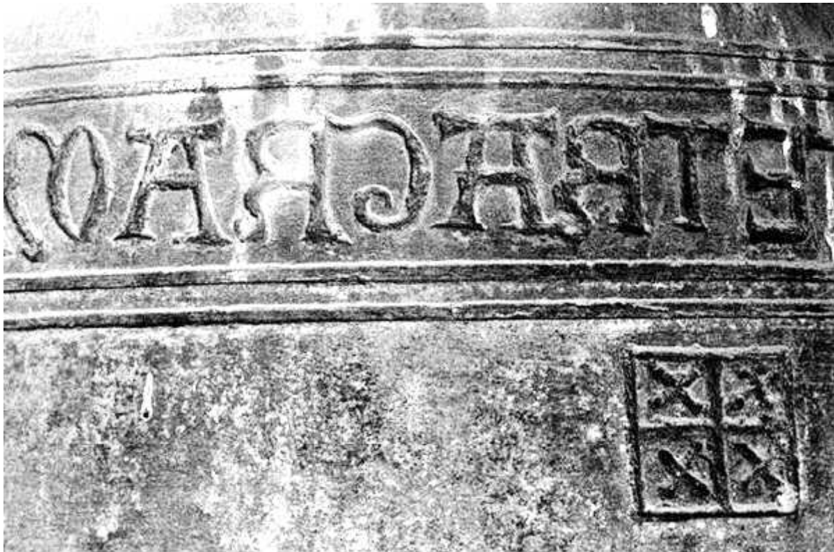
9. rašas varpo frize, išskaptuotas varpo išorinės formos viduje ir viliu nulietas. Friz juosiantys rumbeliai suformuoti naudojant tekimo techniką, XIII a. II p. varpas iš Alberstedto, ev. bažnyčios (Vokietija, Saksonija-Anhaltas).
